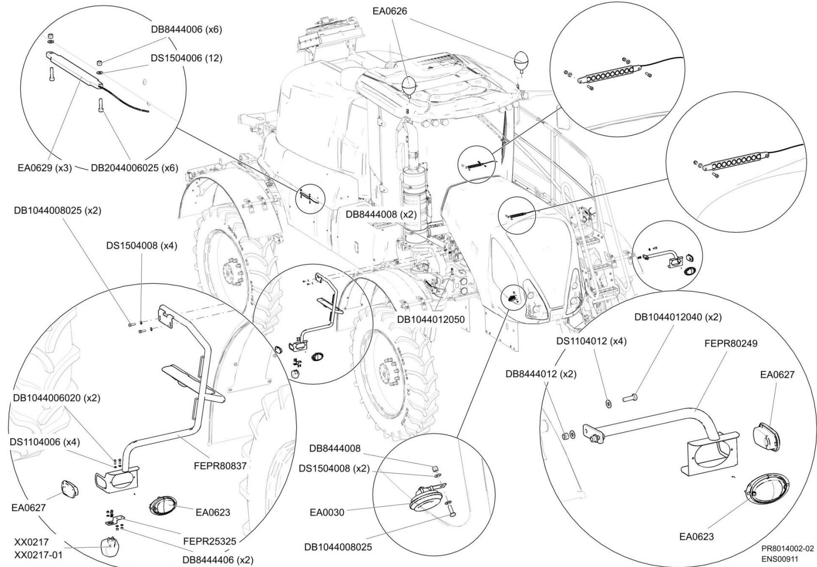
Composants électrique avant T3A - Front electrical components T3A
