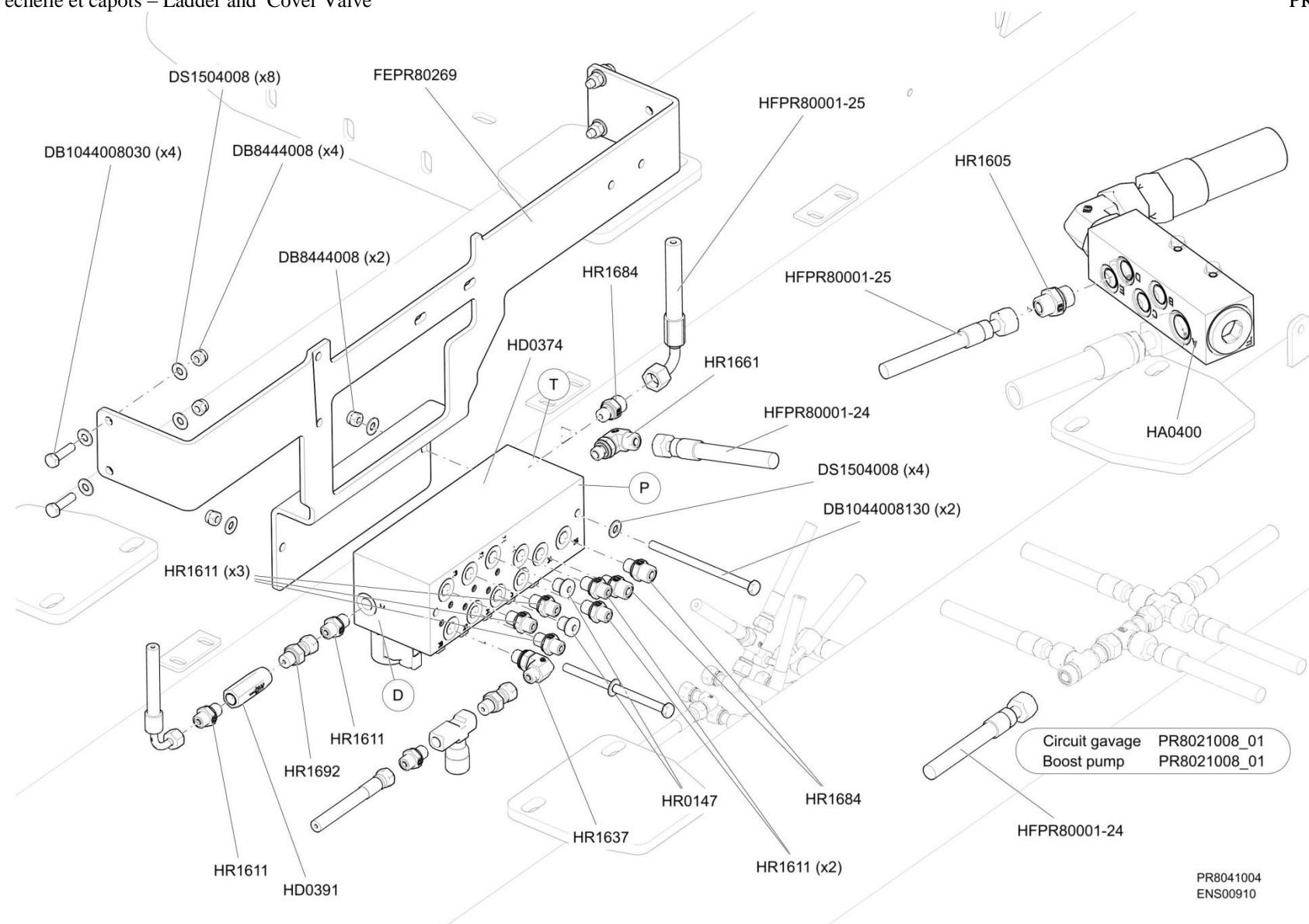
Distributeur échelle et capots – Ladder and Cover Valve
