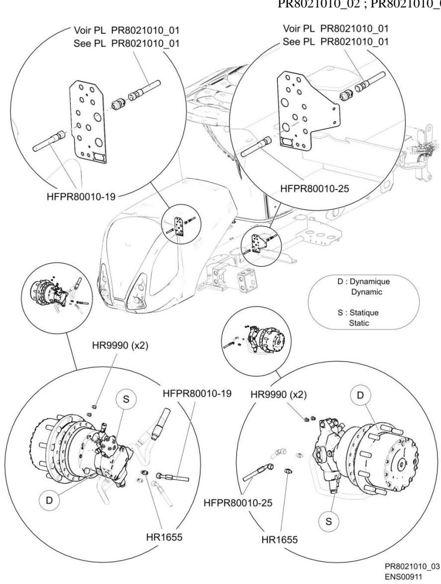
Centrale de freinage dynamique - Dynamic Brake Circuit
