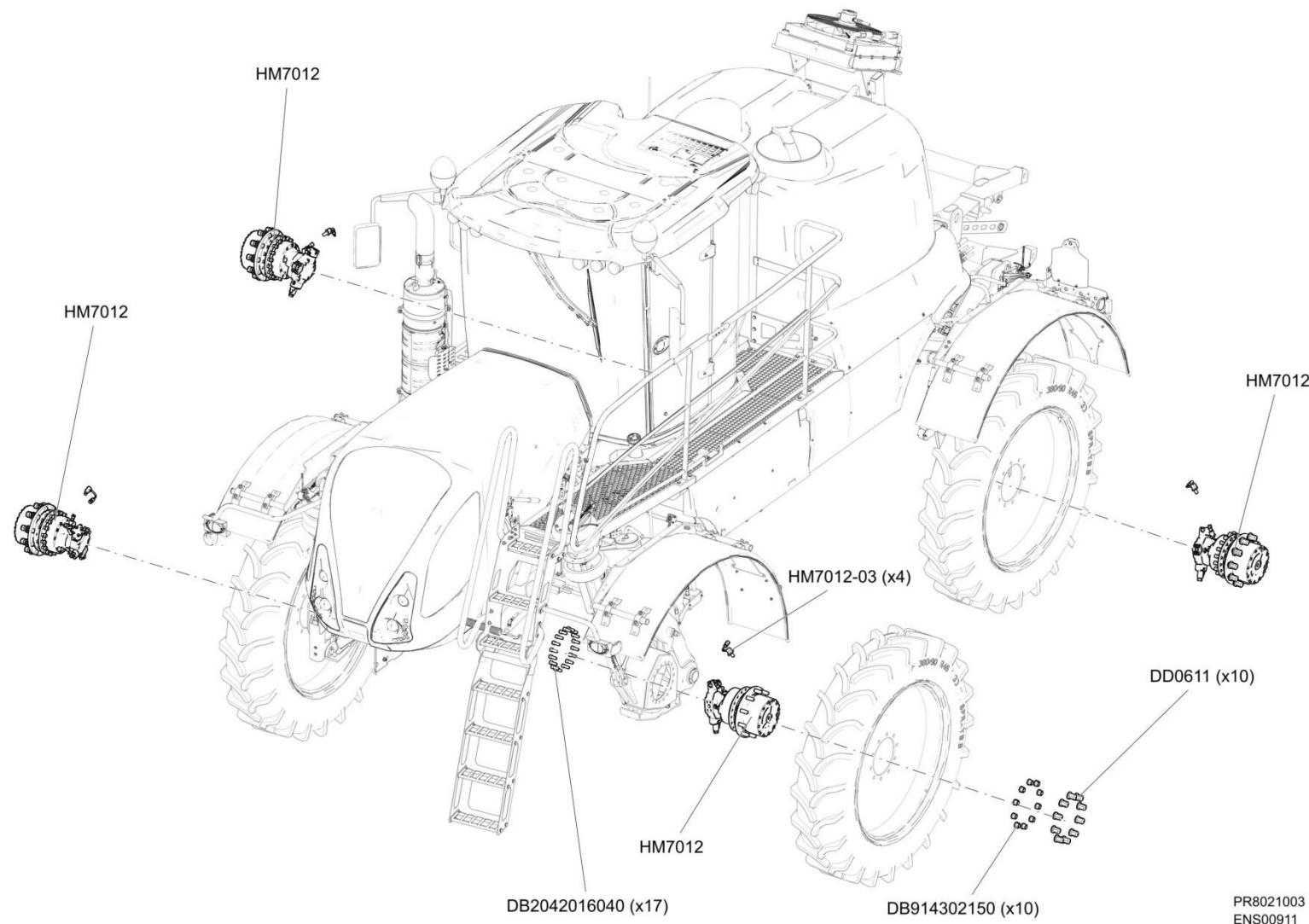
Moteurs hydrauliques - Hydraulic motors
