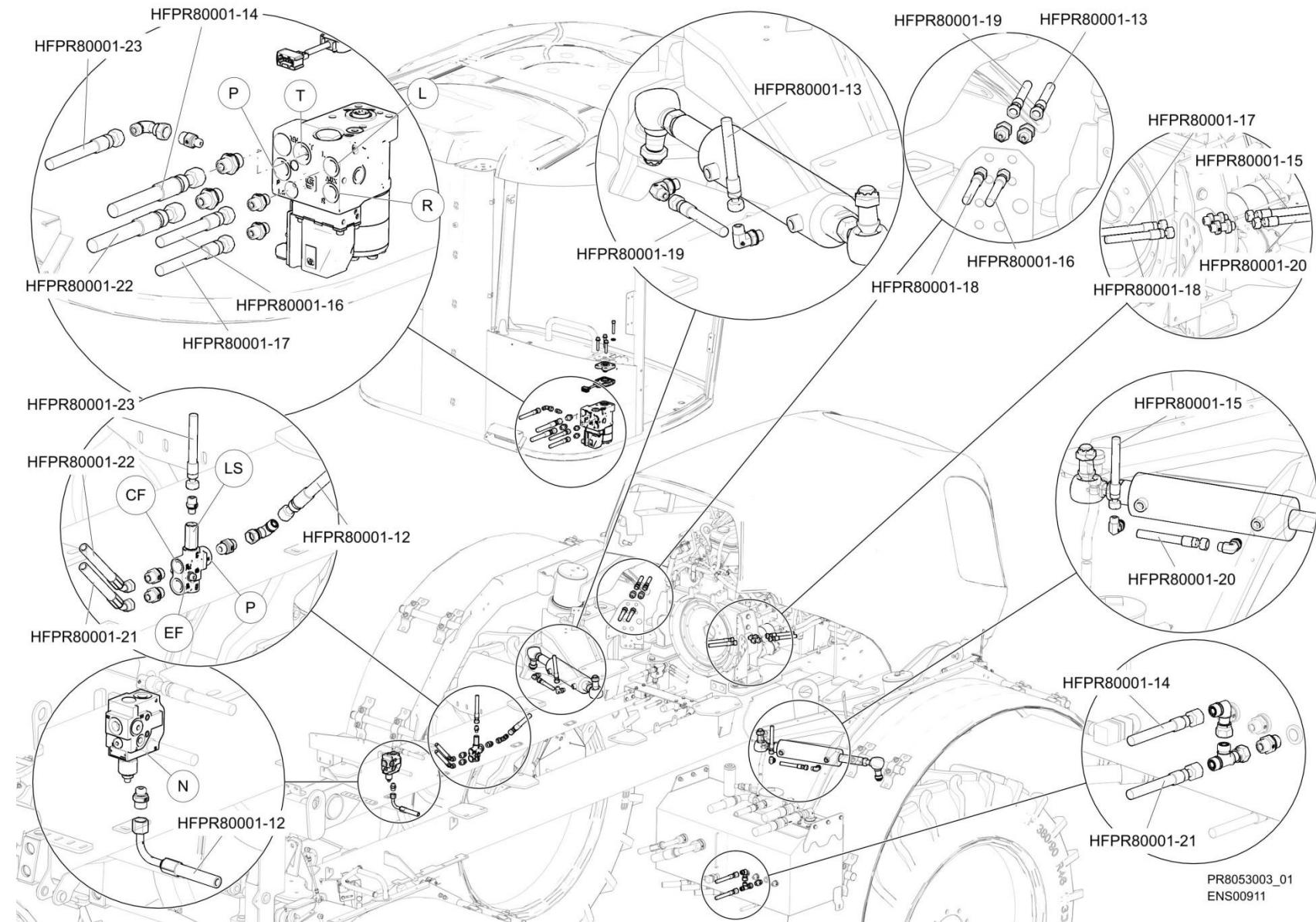
Distributeur option direction arrière – Option Rear Steering Valve
