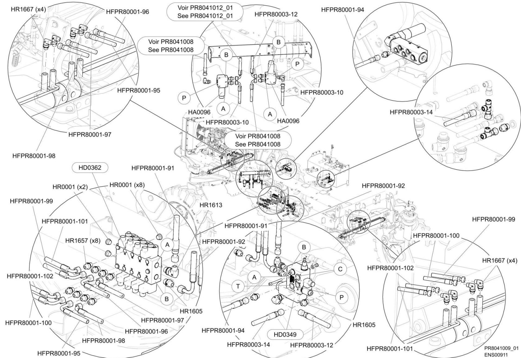
Distributeur 4 fonctions voie variable – 4 Function Valve Hydraulic Track Width Adjustment Valve
