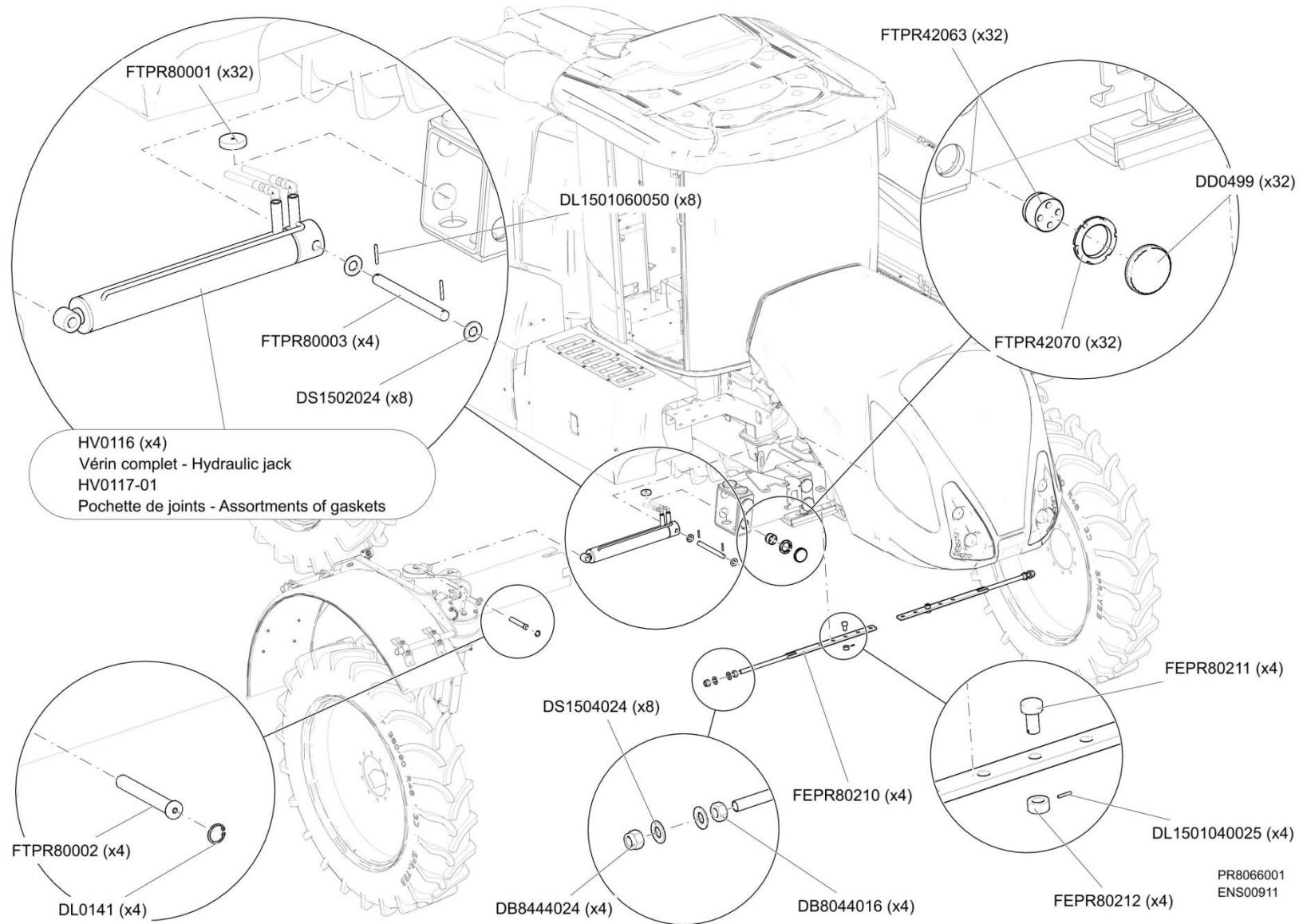
Voie variable avec capteur - Variable Track With Sensor
