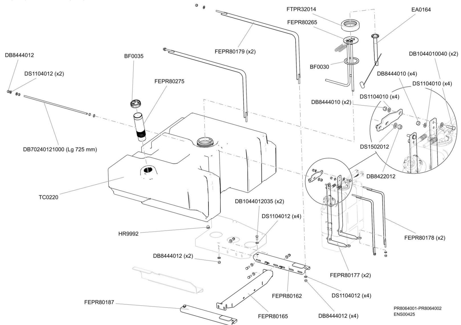
Réservoir carburant (T3A) – Fuel Tank (T3A)
