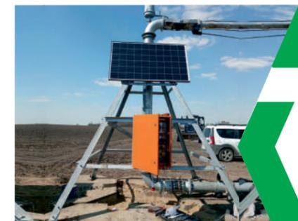
Выполнены из массивных стальных оцинкованных уголков (ГОСТ 8509-93) на болтовом соединении. Конструкция отличается максимальной прочностью, устойчивостью и долгим сроком службы. Центральная опора может быть дополнительно оснащена солнечной панелью для бесперебойного питания сигнализации и модуля связи.
